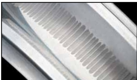
Correntes indesejáveis do eixo podem causar estrias na pista do rolamento, resultando em falha prematura do rolamento
