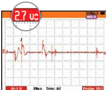
Tensão do eixo com o Inpro/Seal Smart CDR
